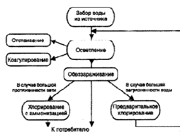
Рис. 2. Основные технологические процессы обработки воды
